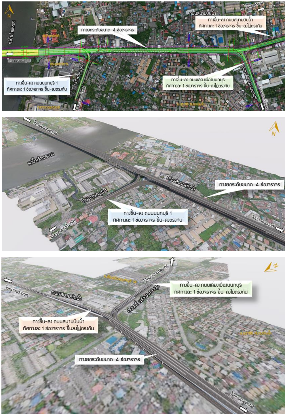
รูปที่ 6.1-3 ทางขึ้น-ลงบริเวณถนนสนามบินน้ำ รูปแบบที่ 3
